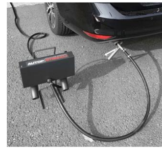
5 pav. Automobilio išmetamųjų dujų analizatorius „SGA 400“
