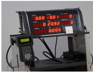
5 pav. Automobilio išmetamųjų dujų analizatorius „SGA 400“
