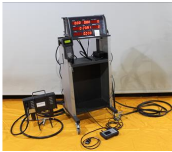
5 pav. Automobilio išmetamųjų dujų analizatorius „SGA 400“
