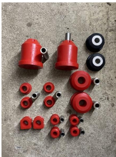
6 pav. Automobilio audi a3 pakabos modifikavimui naudojamos poliuretaninės įvorės
